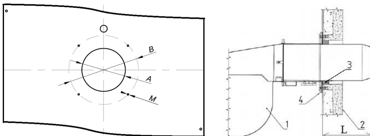
Установочные размеры под горелочное устройство на передней дверце котла.
