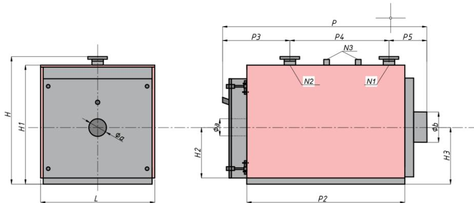
N1/N2 –подающая/обратная магистрали, N3 – выход на предохранительный клапан.
