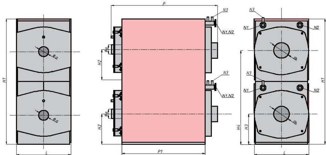
N1/N2 –подающая/обратная магистрали, N3 – патрубок предохранительного клапана.
